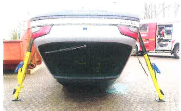
Abb. 10: Stabilisierung mit einem Abstützsystem
