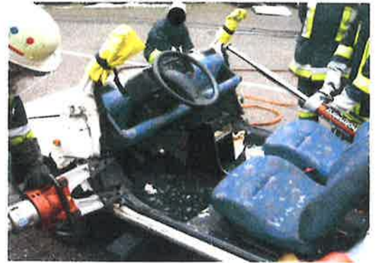
Abb. 24: Vorderwagen abklappen parallel mit Spreizer und Rettungszylinder
