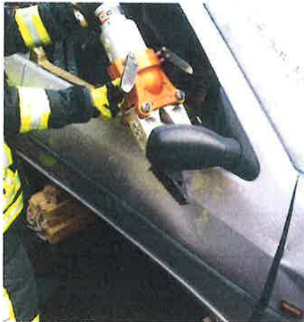
Abb. 15: Zusammendrücken der Fahrzeigtür
