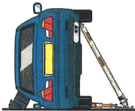
Abb. 7: Stabilisieren mit einem Abstützsystem
