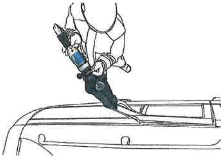
Abb. 18: Spreizer in den entstandenen Spalt einsetzen
