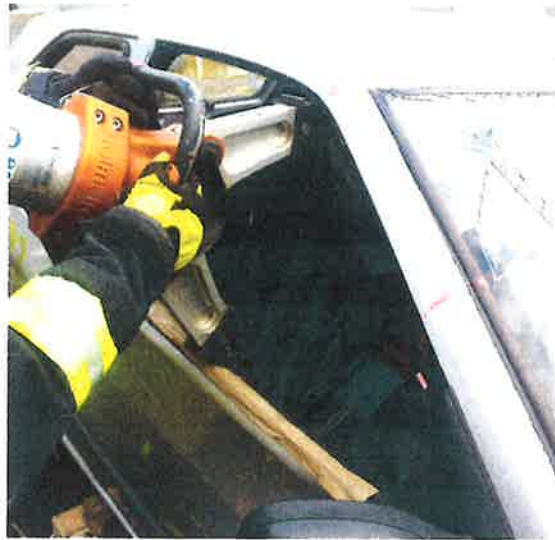
Abb. 14: Spreizer zwischen Dach und Türoberkante
