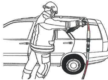
Abb. 17: Fensterrahmen um eigene Achse drehen
