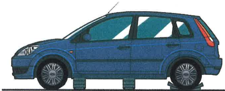
Abb. 4: Sichern und Stabilisieren eines Pkws auf Rädern
