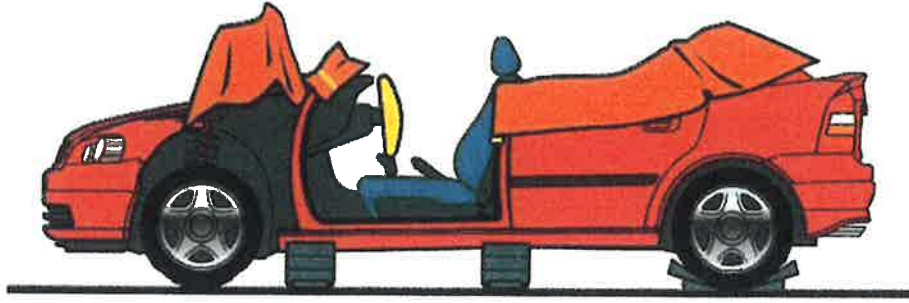
Abb. 21: Komplette Entfernung des Daches
