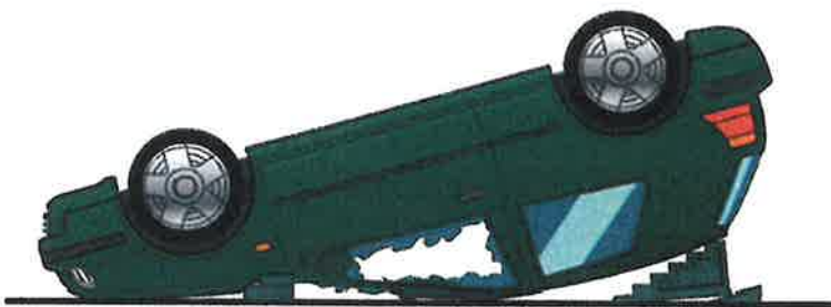
Abb. 11: Unterbauen eines Fahrzeuges auf dem Dach
