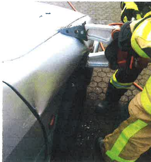
Abb. 13: Zusammendrücken des Kotflügels
