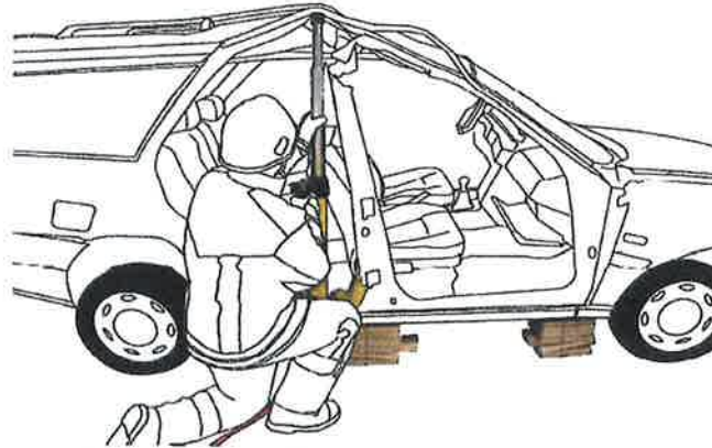
Abb. 26: Abreißen der B-Säule
