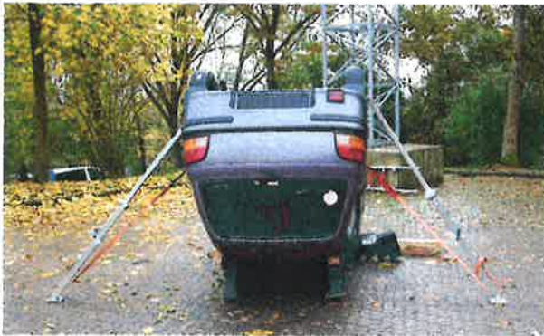
Abb. 9: Stabilisierung mit einem Abstützsystem
