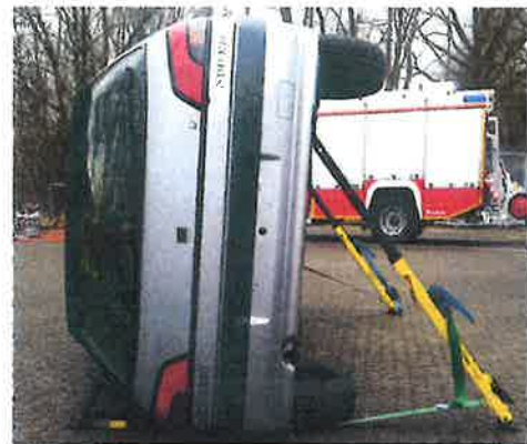
Abb. 8: Stabilisieren mit einem Abstützsystem
