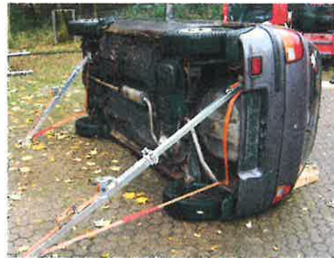
Abb. 6: Stabilisieren mit einem Abstützsystem
